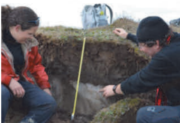
Рис. 2.8.7. Вертикальный разрез многолетнемёрзлых пород с ледяными слоями.
